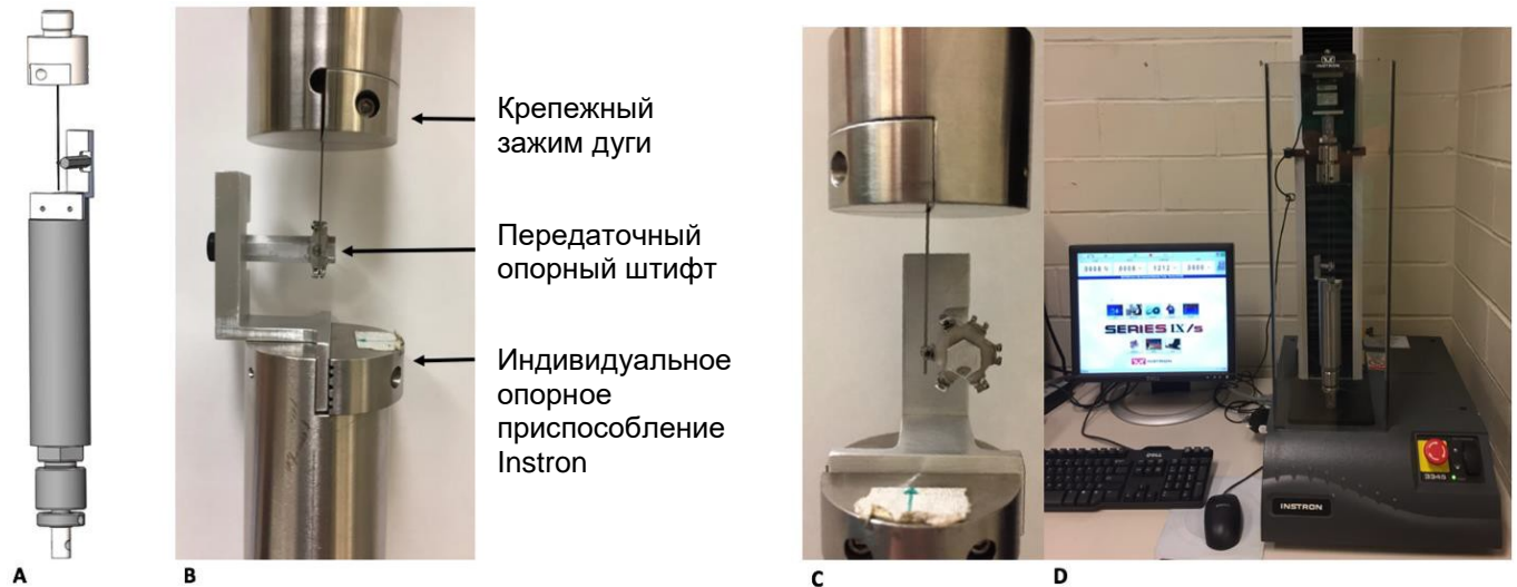
Рисунок 5: Цифровая модель индивидуального опорного приспособления Instron, А. Вид спереди крепежного зажима дуги, удерживающего центрированную проволочную дугу на передаточном штифте с брекетом, закрепленном на индивидуальном опорном приспособлении Instron, В. Вид сбоку индивидуальной установки, С. Испытательная машина Instron с опорными приспособлениями для крепления брекетов, Д.
